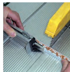
rezanie prepojovacích lišt
