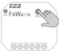
Po správnom pripojení prijímača stlačte a podržte tlačidlo PROG, do momentu, kedy zariadenie prepne výstupný obvod a komunikačná LED dióda zhasne.
