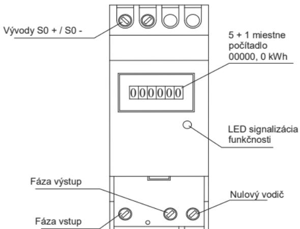
**POUŽITIE:** Jednofázový elektromer CONTAX 3221 S0 pre striedavé napätie, slúži k meraniu činnej elektrickej energie v priamom zapojení do obvodu. Je určený na podružné merania spotreby samostatných spotrebičov alebo spotrebičov v skupinách.
